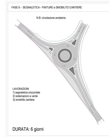
SCHEMA LAVORAZIONI TIPO - isole spartitraffico
